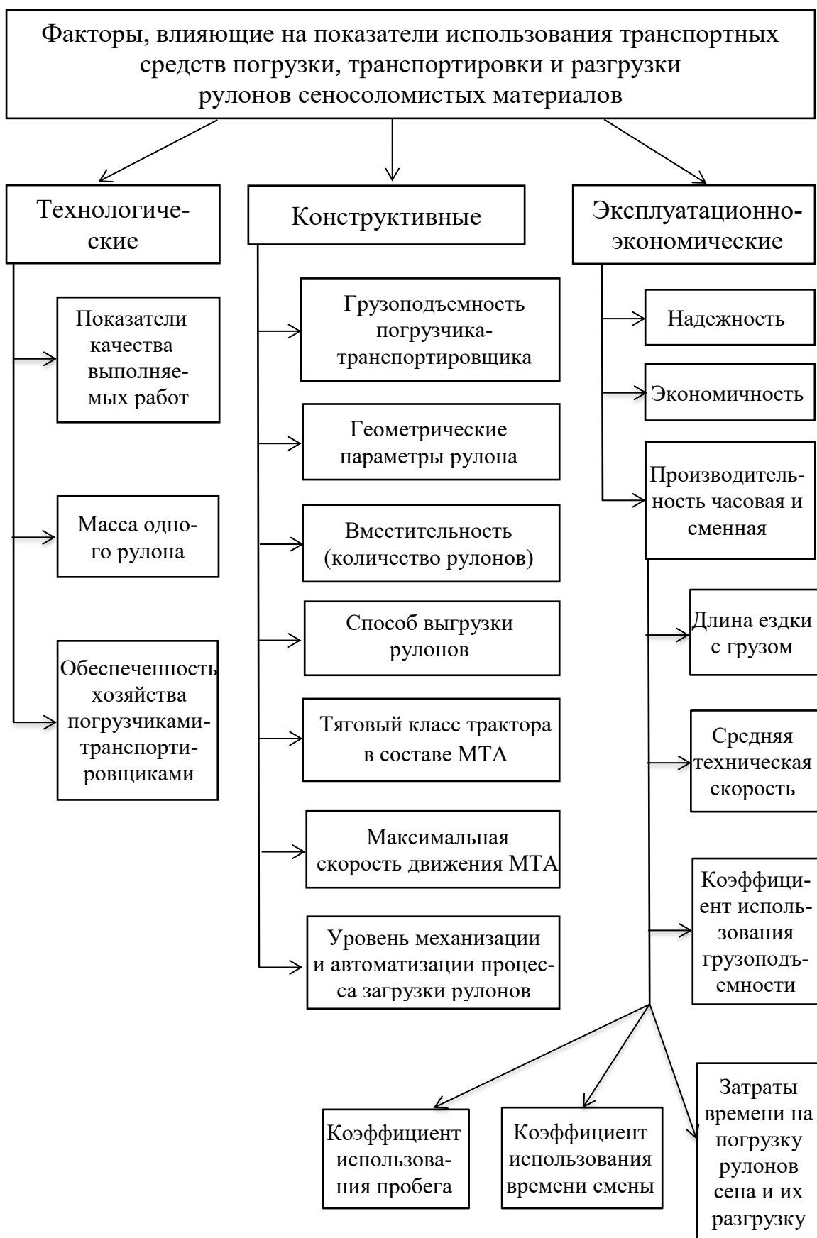
Рисунок 2.15 – Факторы, влияющие на показатели использования транспортных средств на уборке с поля рулонов сена
