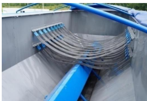
Рисунок 1.4 – Устройство в кузове полуприцепа «Тонар – 95235» для снижения уровня повреждений клубней картофеля
