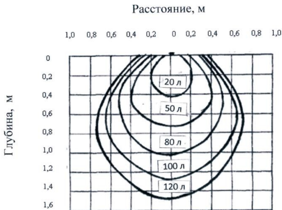
Рисунок 1 – Контур увлажнения почвы при подаче объема воды, равным 20, 50, 80, 100 и 120 л
