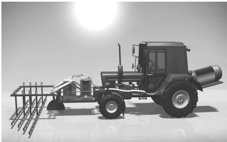
Рисунок 1 – Электроимпульсный пропольщик, навешиваемый на колёсный трактор
