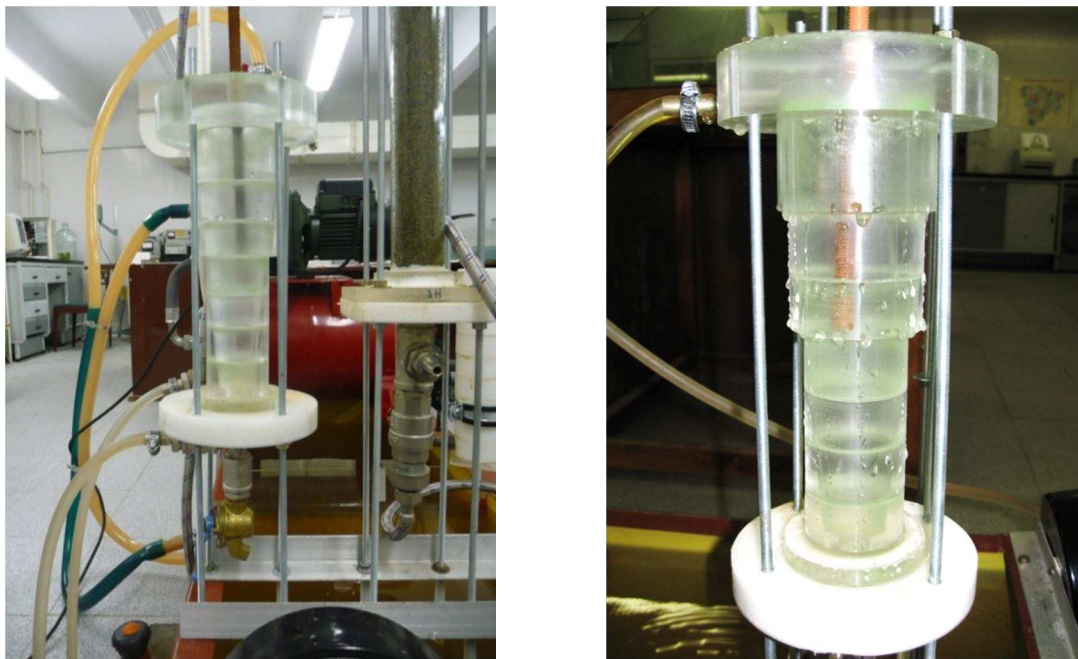
Рисунок 1 – Экспериментальная установка испытания гидроциклона и напорного фильтра с цеолитовой загрузкой
