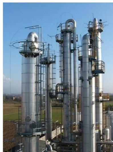
Рисунок 2 – Ректификационная колонна для производства спирта-сырца и спирта ректификата
