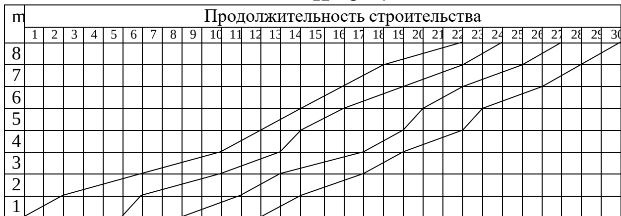
Рис. 2.5. Циклограмма неритмичных потоков с неоднородными и некратными ритмами
