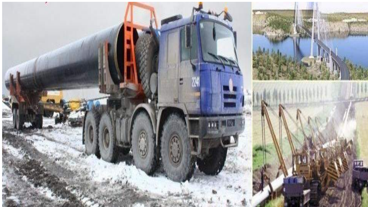
Рис. 5.3. Транспортировка труб большого диаметра
