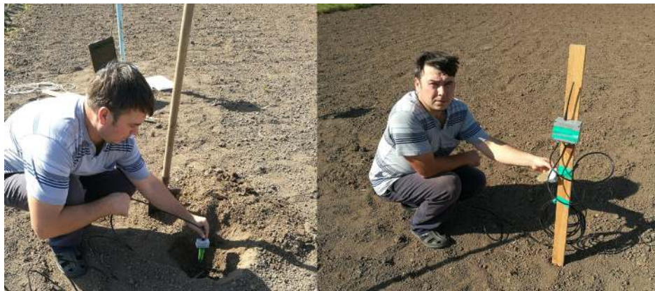
Рисунок 3 – Подключение и установка беспроводных модулей для оценки параметров почвы и индикатора влажности листа
