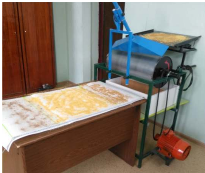
Рисунок 1 – Лабораторная установка и распределение вороха горчицы после очистки на пневмомеханическом сепараторе
