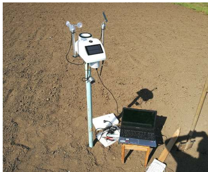
Рисунок 2 – Установка и подключение метеорологической станции «Сокол-М» на месте
