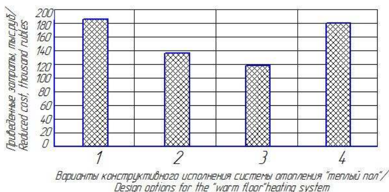
Рисунок 7 – Изменение приведенных затрат в зависимости от варианта конструктивного исполнения системы отопления «теплый пол»
