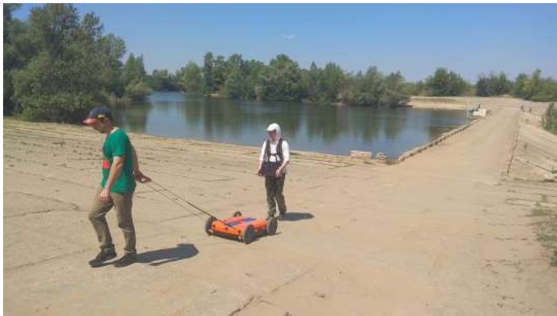
Рисунок 1 – Георадарная съемка объекта исследования антенным блоком АБ 150/400
