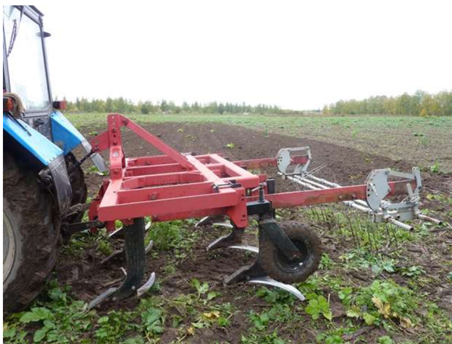
Рисунок 1 – Общий вид комбинированной почвообрабатывающей машины КПМ-2.7 с рабочими органами серпообразной формы в агрегате с трактором МТЗ-82.1
