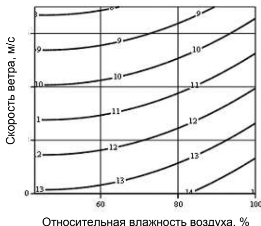
Рисунок 4 – Сечение поверхности отклика: зависимость температуры воздуха в помещении от влажности и скорости движения наружного воздуха при его температуре -5^{\circ}\text{C}
