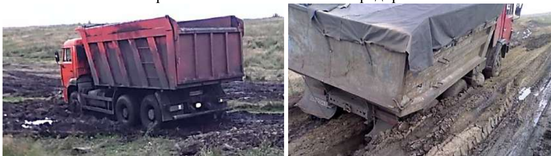
Рисунок 1 – Работа грузовых автомобилей в полевых условиях на почвах с малой несущей способностью
