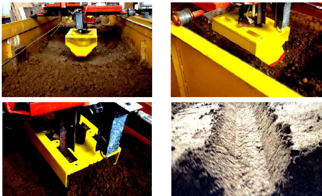
Рисунок 2 – Испытание модели рабочего органа каналоочистителя – ковша трапецидального профиля в лабораторных условиях
