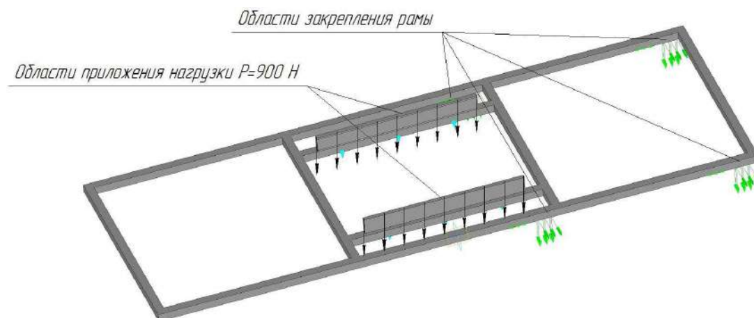
Рисунок 4 – Схема закрепления рамы и приложения нагрузки к механизму продольного перемещения кузова и кабины
