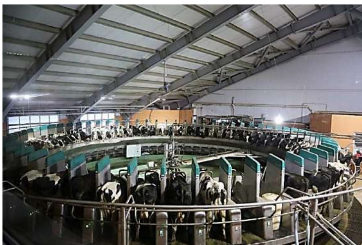
Рисунок 2 – Роботизированная карусель для доения коров в ООО СП «Донское»
