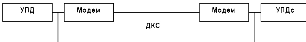
Рис. 2.1. Структурная схема канала передачи данных
