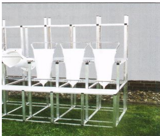
Рисунок 13 - Аппарат обесклеивания икры (АОИ)
