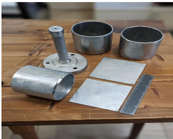
Рисунок 3.3-Цилиндр для определения объемного веса почвы в обрабатываемом слое
