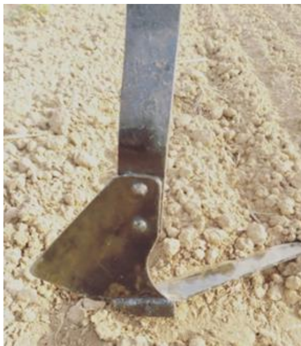
Рисунок 4.31– Тестирование модернизированных полольных лап культиватора при междурядной обработке посевов
