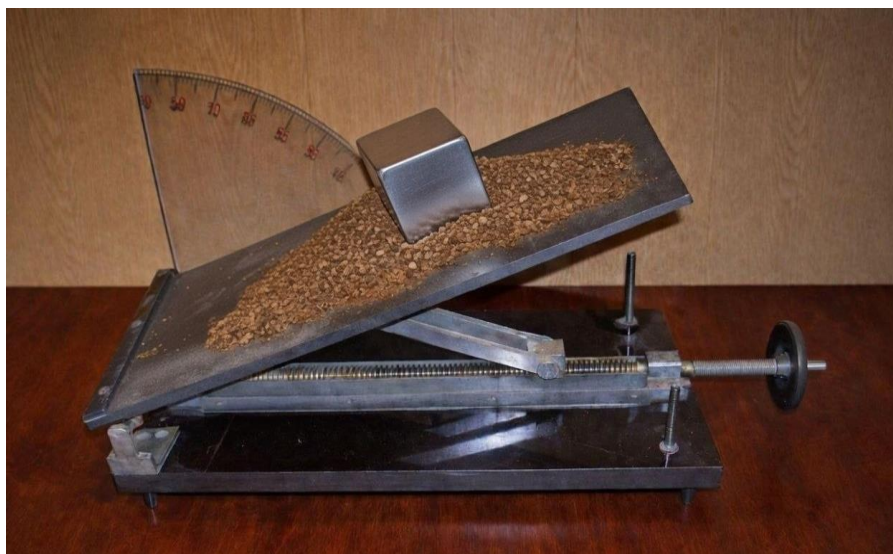
Рисунок 3.5-Определение трения покоя
