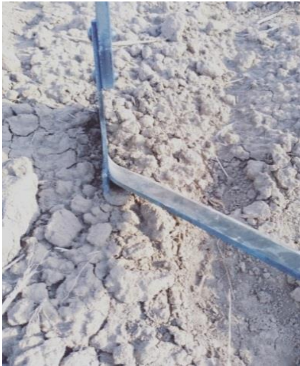
Рисунок 3.21- Полольная лапа культиватора для обработки почвы.
