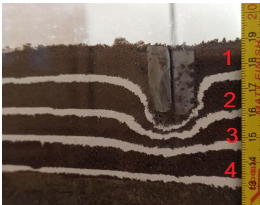
Рисунок 4.17- Деформация почвы при погружении прямоугольного тела
