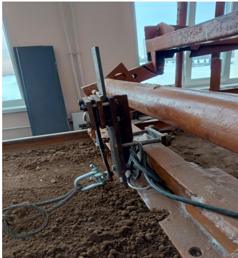
Рисунок 3.20 – Датчики для определения тягового сопротивления.
