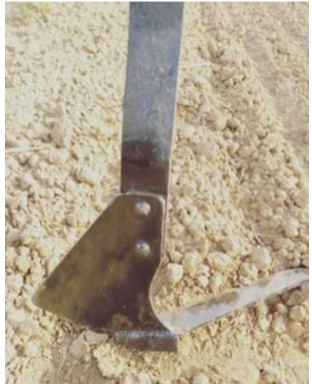
Рисунок 3.21- Полольная лапа культиватора для обработки почвы.
