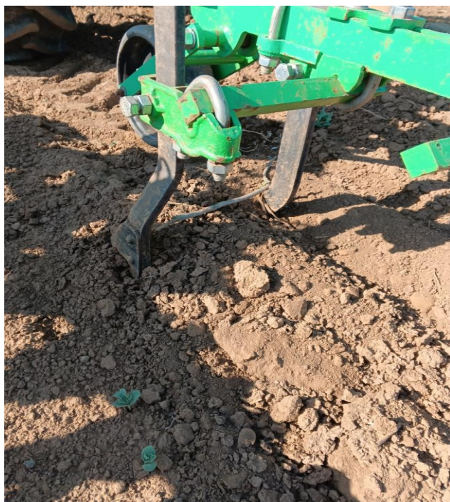
Рисунок 4.31– Тестирование модернизированных полольных лап культиватора при междурядной обработке посевов
