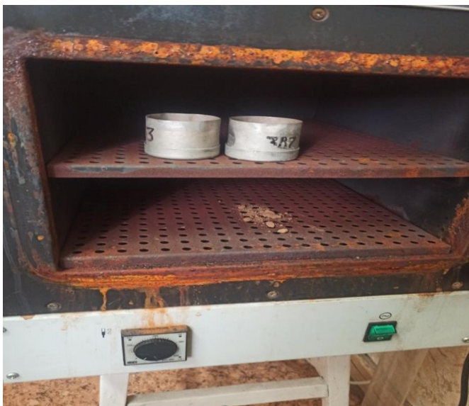
Рисунок 3.1 - Печь для просушивания образцов почвы
