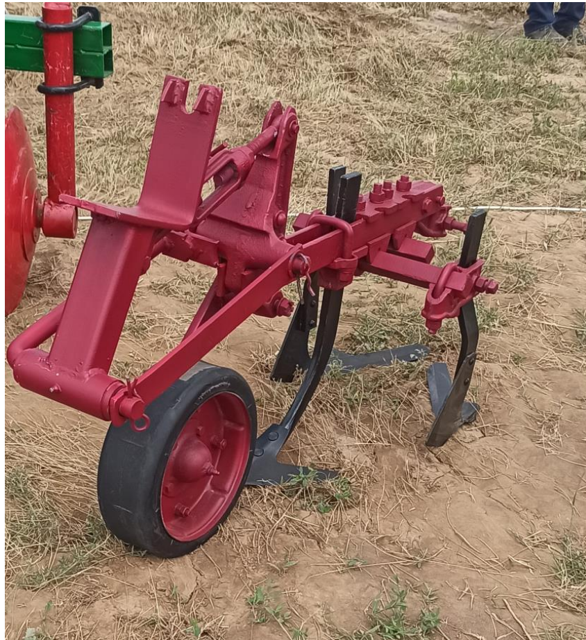
Рисунок 3.23- Секция культиватора с модернизированными лапами
