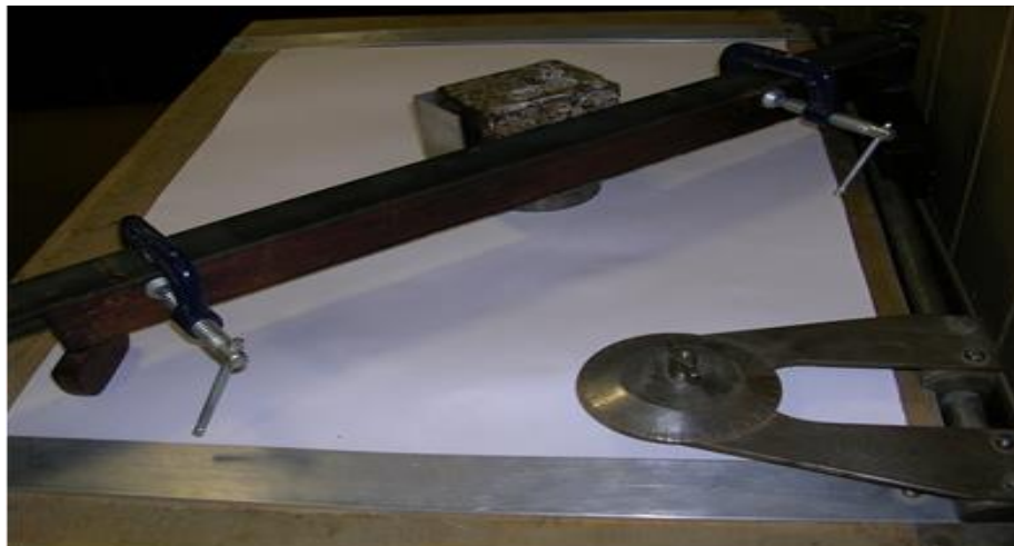
Рисунок 3.7. –Определение трения движения
