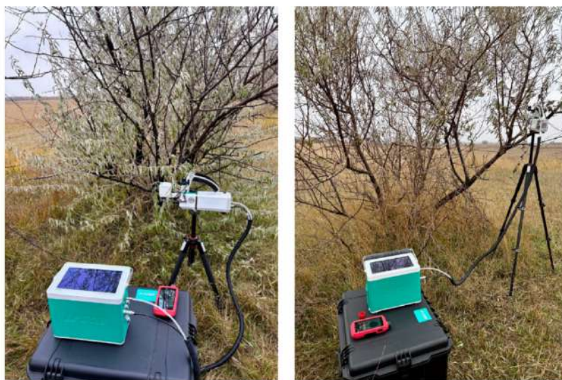
Рисунок 3 – Работа портативной системы газообмена Li-cor 6800 в полевых условиях Figure 3 – Operation of the Li-cor 6800 portable gas exchange system in the field
