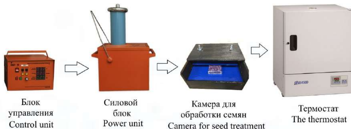
Рисунок 1 – Структурная схема проведения опытов по влиянию электрического поля переменного напряжения на лабораторную всхожесть семян подсолнечника
