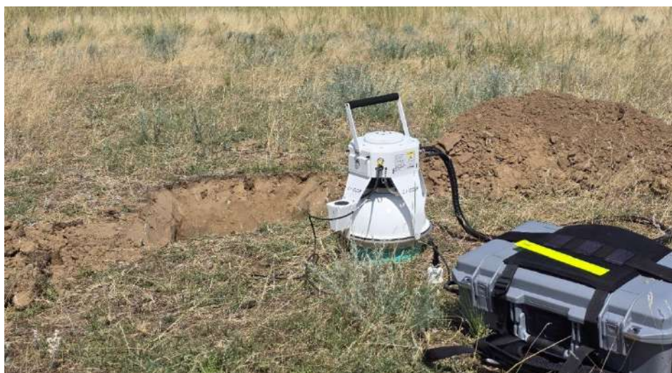
Рисунок 4 – Стационарное основание и камера Smart Chamber в комплексе с газоанализатором модели LI-7810
