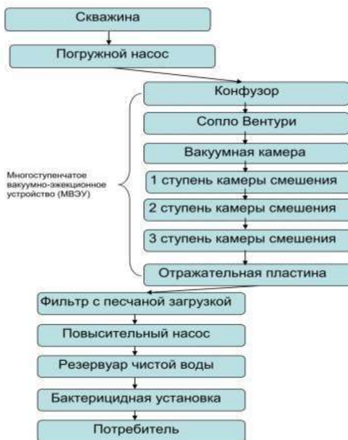
Рисунок 1 – Технологическая схема обезжелезивания подземных вод вакуумно-эжекционным методом Figure 1 – Technological scheme of underground water de-ferrousing by the vacuum-ejection method
