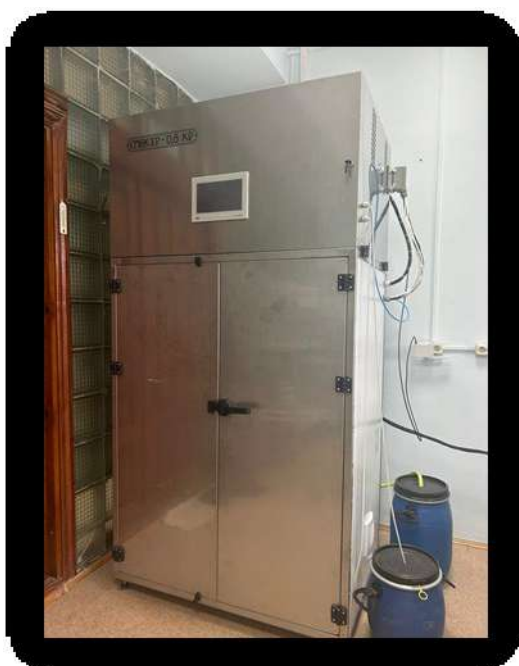
Рисунок 1 – Климатическая камера роста «Спектр-0,8 КР» Figure 1 – «Spectr-0.8 KR» climate growth chamber
