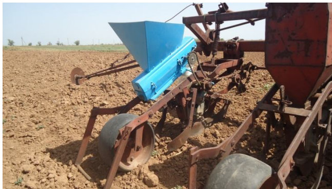
Рисунок 5 – Установка разработанного высевающего аппарата на сеялке СУПН – 8 при полевых испытаниях
