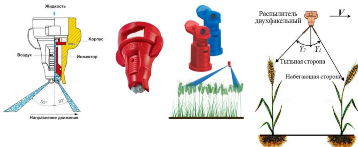
Рисунок 3 – Схема работы форсунок IDTA (Lechler) и AI3070 (Teejet) Figure 3 – Scheme of operation of IDTA (Lechler) and AI3070 (Teejet) injectors
