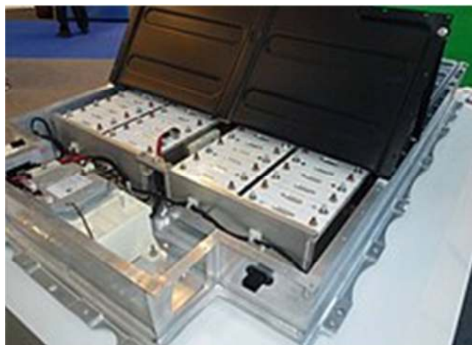
Рисунок 2 – Литий-ионные аккумуляторы на электромобиле Figure 2 – Lithium-ion batteries on an electric vehicle
