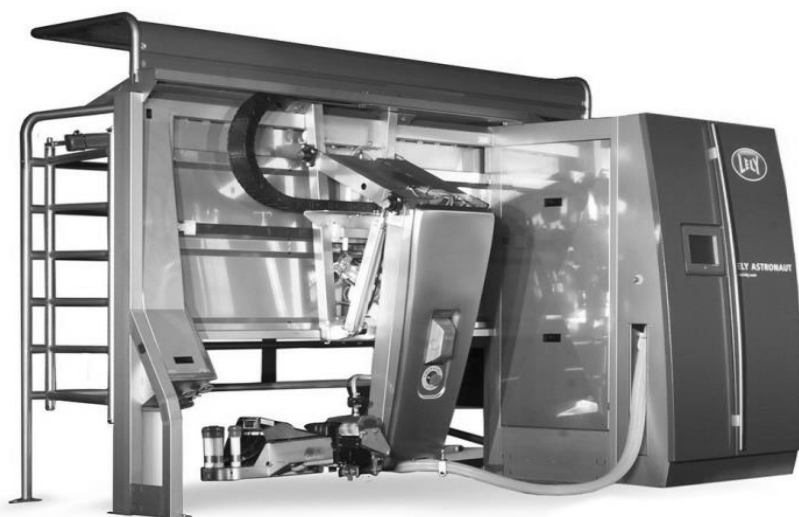
Рисунок 7 – Новое поколение робота-дояра Lely Astronaut A4
