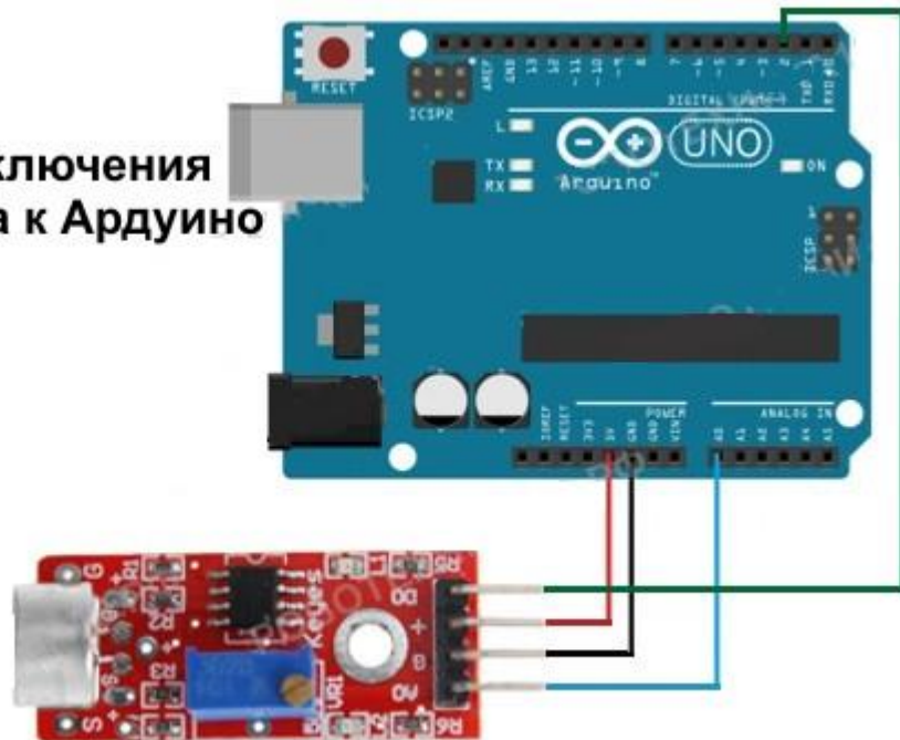
Рисунок 1.23 – Схема подключения датчика звука к Arduino UNO
