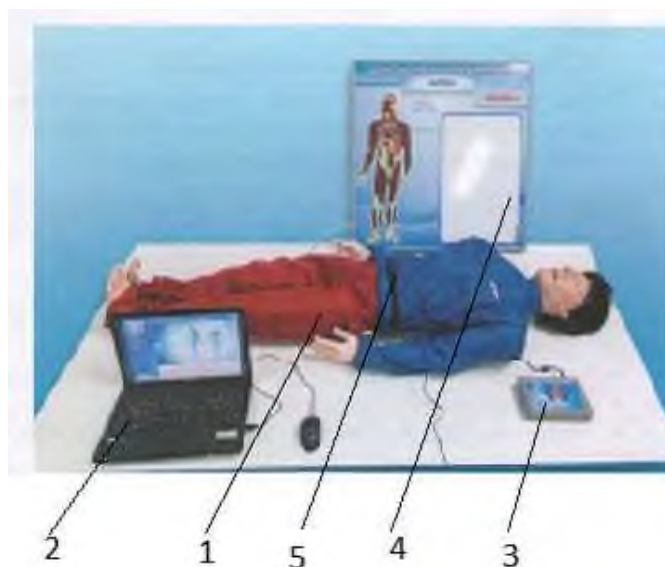
Рисунок 5 – Робот тренажер, общий вид: 1 – манекен-тренажер, 2 – ноутбук, 3 – выносной электрической контроллер, 4 – анатомическое маркерное табло, 5 – поясной ремень.
