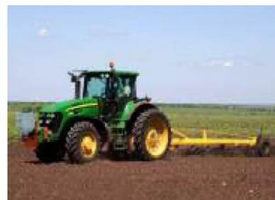
Использование разбрасывателя Polaro® в пахотном агрегате позволяет точно настраивать ширину разбрасывания удобрений в соответствии с шириной плуга. А применение рабочих органов «РАНЧО» позволяет устанавливать величину обрабатываемого пласта 10-15 см, независимо от глубины рыхления.
