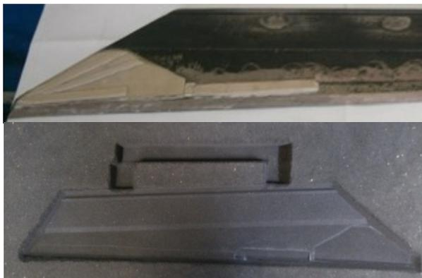
Рисунок 1 – Модель и форма лемеха с легированной режущей кромкой в зоне носка.
